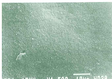
(圖 15-1) 緻密型 HA 放大圖 (× 1500) 未呈現任何大孔或微孔 ( Ceramed 公司產品)
